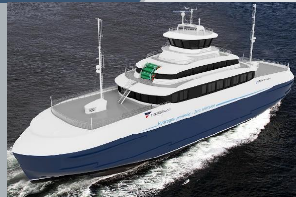
Verdens første ombygging til hydrogen hybrid ferge. Kilde: Fiskerstrand Holding
